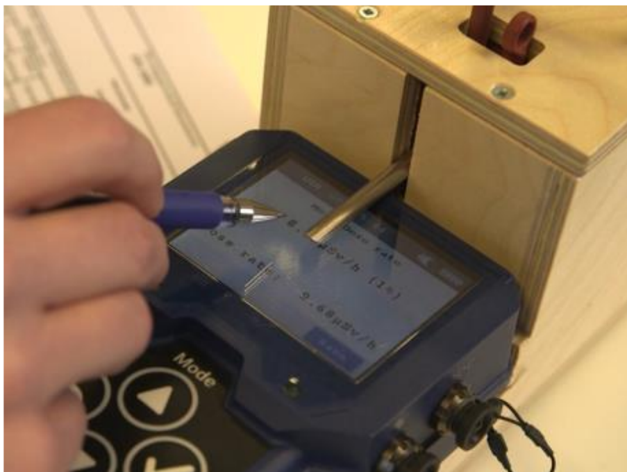
Figur 2. Saphyrad-S placerat i intensimeterprovaren "kyrkan". Foto: MSB
