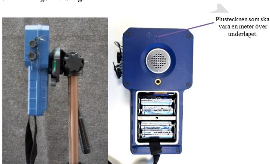
Figur 3. Saphyrad från sidan monterad på stativet. Plustecknen på baksidan används som markör för avståndet 1 meter till underlaget. Foton: Hans Källström (MSB)
