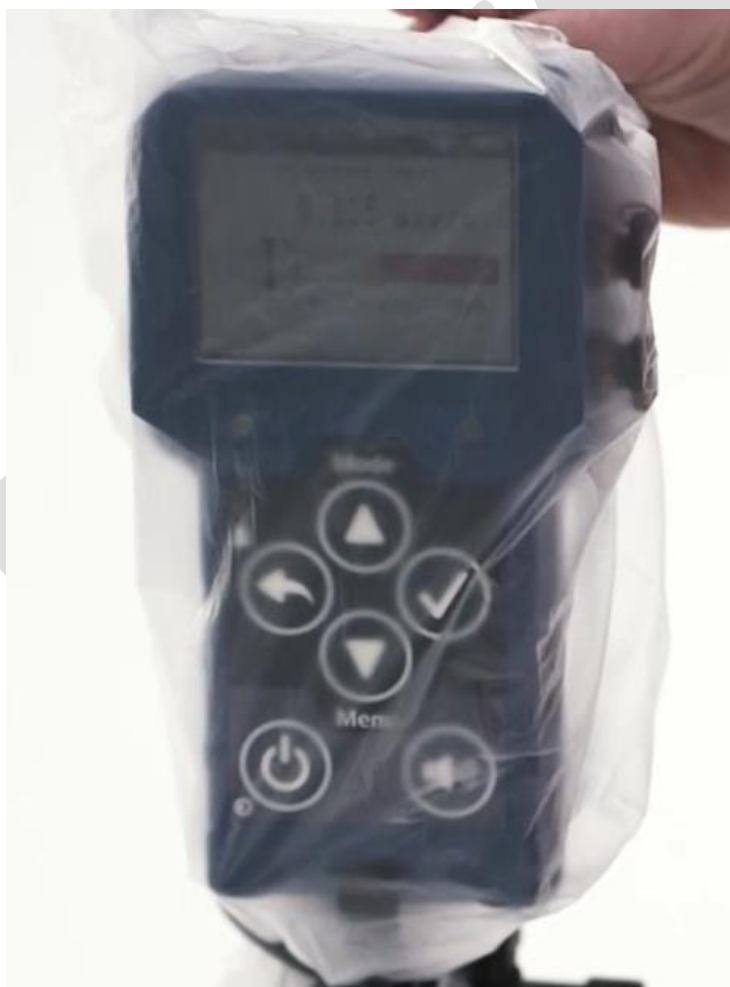
Figur 2. Mätinstrumentet Saphyrad-S skyddas med dubbla plastpåsar för att inte kontamineras (bildkälla: MSB webbkurs Saphyrad-S)
