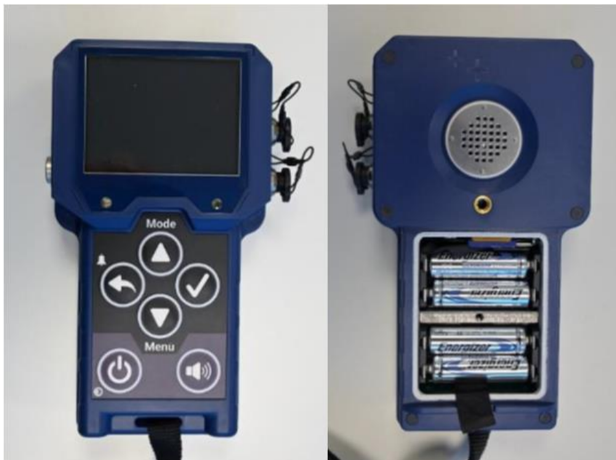
Figur 1. Framsida och baksida av instrumentet Saphyrad-S, foton Hans Källström, MSB
